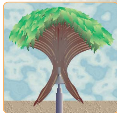
Figura 4.20. Corte longitudinal del drago con el soporte de acero que planeó Allen
