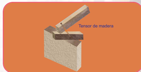
Figura 5.64. Tensor colocado con el lado mayor como base del rectángulo de la sección
