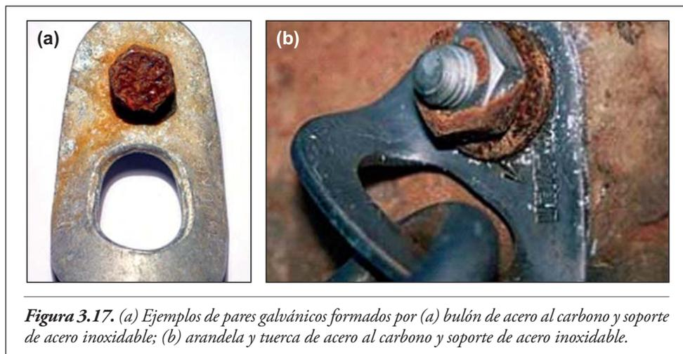
**Figura 3.17.** (a) Ejemplos de pares galvánicos formados por (a) bulón de acero al carbono y soporte de acero inoxidable; (b) arandela y tuerca de acero al carbono y soporte de acero inoxidable.
