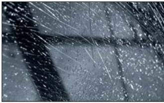
**Figura 5.12.** *Crazing sobre un parabrasis de automóvil fabricado de policarbonato.*
