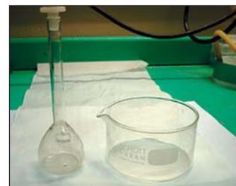
**Figura 4.33.** Recipientes de uso en laboratorios químicos construidos con vidrio de borosilicato.
