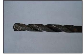
**Figura 4.8.** Mecha de vidia utilizada para perforar paredes. Su punta es un cermet de carburo de tungsteno cementado con cobalto (WC - Co).
