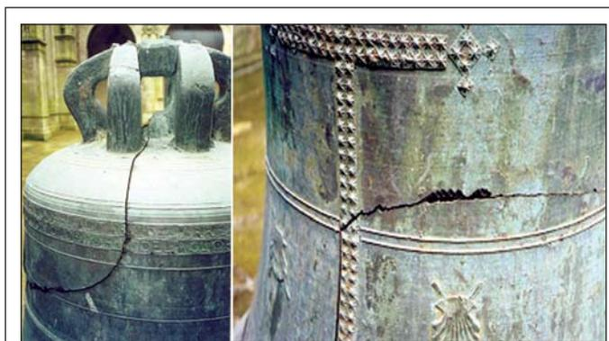
**Figura 3.30.** Fisuras en campanas de bronce debidas a corrosión bajo tensión. Catedral de Santiago de Compostela, España.
