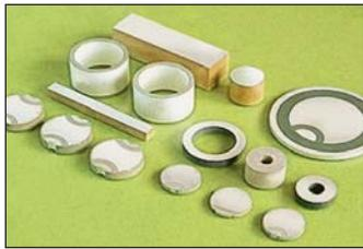
**Figura 4.28.** Piezas de polvo de PZT sinterizado para distintos usos comerciales.
