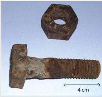
**Figura 1.1.** Tuerca y tornillo de acero utilizado en la construcción del Ferrocarril Trasandino, Estación Las Cuevas, Provincia de Mendoza, Argentina.
