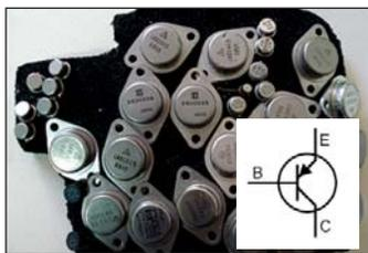
**Figura 4.13.** Transistores de estado sólido de distinta potencia y su representación simbólica.
