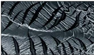
**Figura 5.13.** *Fisuras sobre una pieza de Policarbonato que sufrió "Environmental Stress Failure".*
