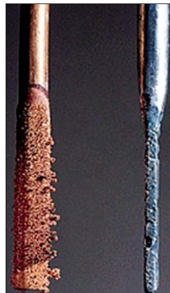
**Figura 3.15.** Electrodo de cobre y cinc luego de haber estado cortocircuitados en la pila de Daniell un tiempo prolongado. Se nota cómo se engrosó la barra de cobre en su parte sumergida en la solución de  $CuSO_4$  (inferior) por el depósito de Cu desde la solución y cómo se adelgazó la barra de cinc por corrosión.
