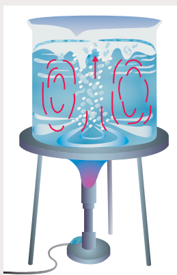
Figura 4.7. Proceso de desarrollo de corrientes convectivas en un fluido
