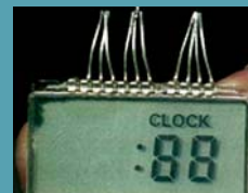
● Una pantalla común de cristal líquido se arruina, si se le aplica tensión continua durante mucho tiempo. Si a pesar de eso se le dan, por ejemplo, 9 V en serie con la resistencia de los dedos de la mano, y se quita esa tensión, la pantalla queda con los segmentos marcados durante varios segundos, y después se apagan. En cambio, las pantallas biestables quedan con su indicación permanente, hasta que se les aplique una tensión inversa adecuada. La pantalla de la figura se dejó de alimentar cinco segundos antes de la foto.
