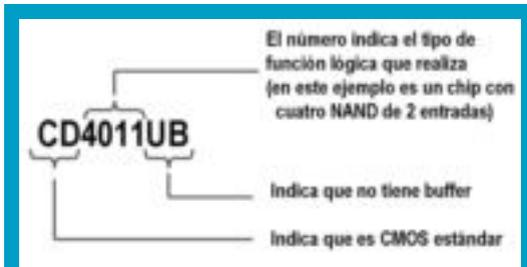
*Identificación de un dispositivo CMOS de la serie 4000 sin buffer a la salida*
