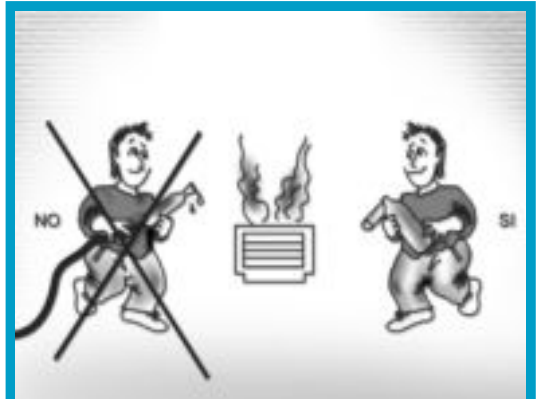
Forma correcta de apagar incendios en aparatos eléctricos (con extintores de nieve carbónica)
