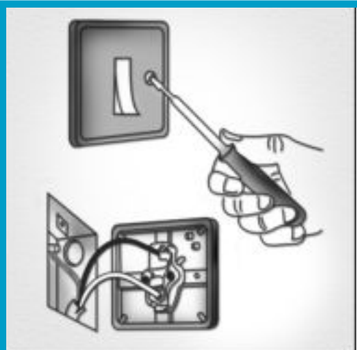
Sustitución de un interruptor
