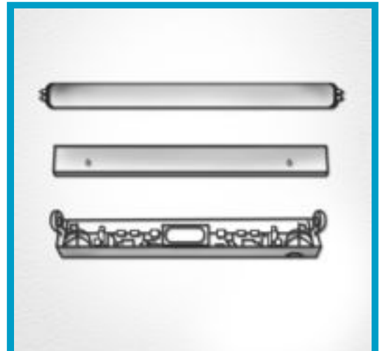
Para instalar un tubo fluorescente, pase los conductores y conecte los terminales a los bornes
