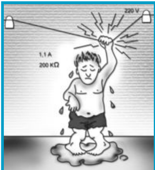
Mal aislamiento (piel mojada)
