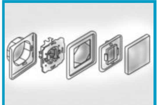
Los enchufes con protección contra proyecciones de agua se pueden utilizar en el jardín; las distintas partes de que se componen son: zócalos, marcos y tapas.
