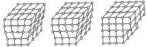
Movimiento de una dislocación de borde
