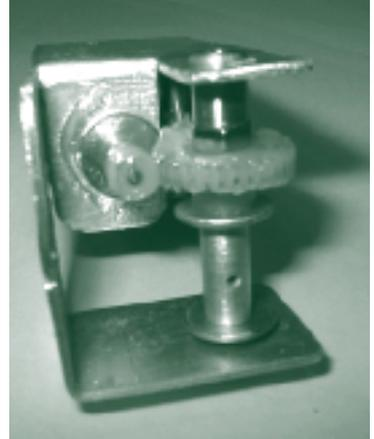
engranajes sin fin y corona. El conjunto está soportado en una estructura de aluminio doblado que, a su vez, sirve para sujetarlo a la estructura del invernadero.
