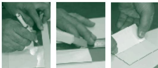
**Paso 3.** Colocamos la filmina, con el diseño del circuito del lado del cobre, sobre la placa fotosensible, a la cual le hemos quitado el film protector. Sugerimos colocar un vidrio o acrílico transparente para evitar que la filmina se deforme o se deslice. Sometemos a este conjunto a la acción de luz ultravioleta (lámpara de bajo consumo) durante un tiempo de, aproximadamente, 10 minutos.
