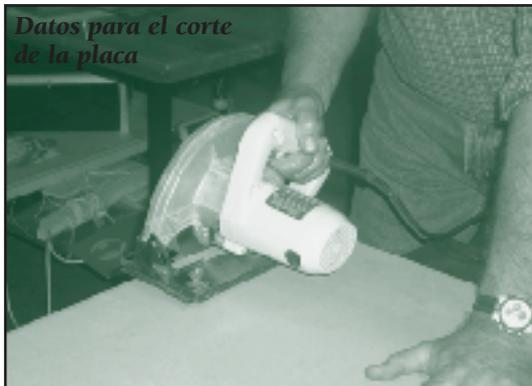
La pieza M-1 es la que realmente sirve de apoyo al invernadero. En nuestro modelo, realizamos una terminación en los bordes del tipo pecho de paloma, ya que contamos con un tupí manual; pero, esta operación no es imprescindible ni necesaria: la terminación queda a criterio del equipo encargado de la construcción que tenga esta tarea, la que puede consistir, simplemente, en el limado de los cantos.
