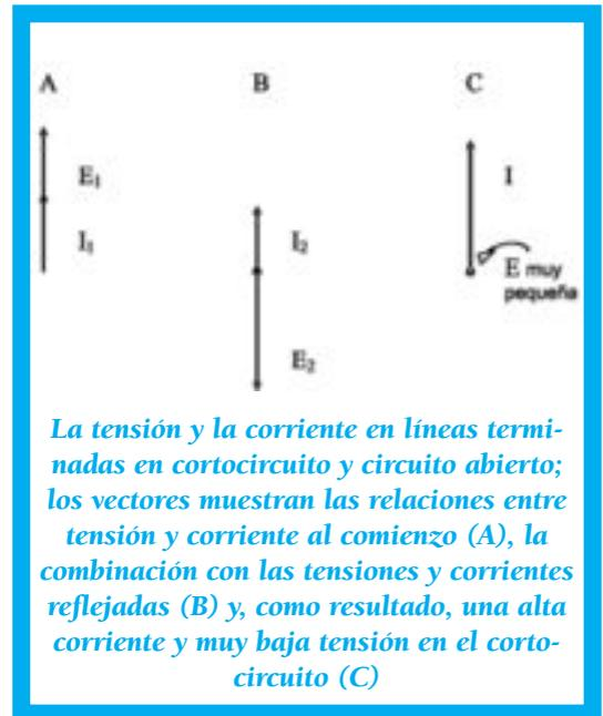
La corriente, sin embargo, no desaparece en el cortocircuito. En realidad, la corriente incidente fluye a través del cortocircuito y existe, además, una componente reflejada en fase y de la misma amplitud. La tensión reflejada y la corriente deben tener la misma amplitud que la tensión y la corriente incidentes, debido a que no se utiliza potencia en el cortocircuito y que éstas retornan a la fuente.
