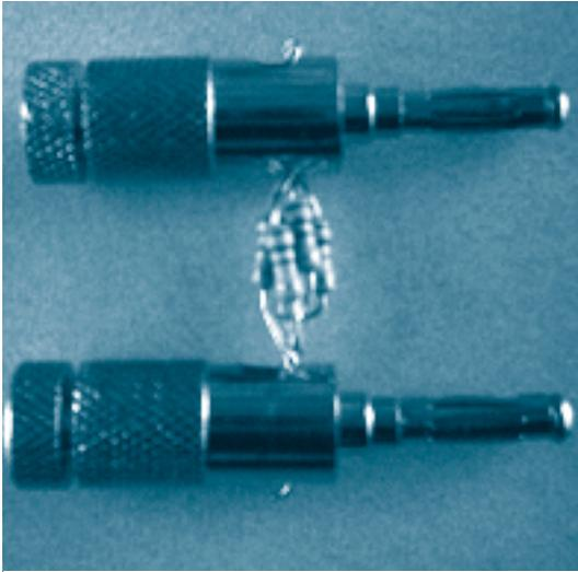
Resistencia de carga de 200 ohm. Implementada con cinco resistores de 1000 ohm cada uno, conectados en paralelo con el objeto de disminuir el efecto inductivo
