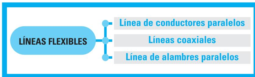
Las líneas de transmisión en las cuales los conductores están separados por un dieléctrico flexible tienen algunas ventajas con respecto a los aislados con aire. Son menos voluminosos, más livianos y mantienen más constante el espaciado entre conductores. Por otra parte, su instalación es más fácil.
