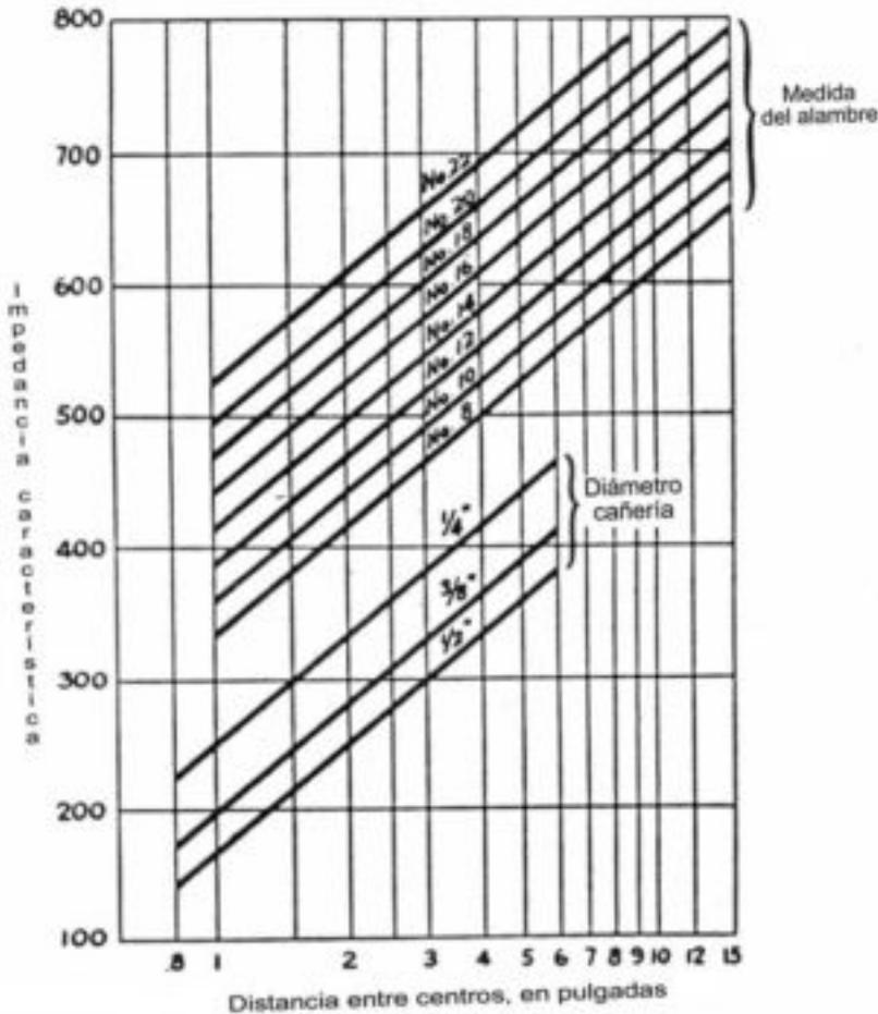
Impedancia característica en función de la medida del conductor y en función del espaciado, para líneas de conductores paralelos
