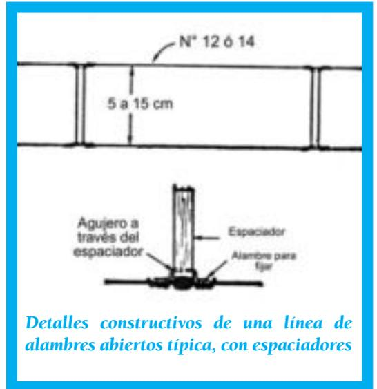
Detalles constructivos de una línea de alambres abiertos típica, con espaciadores
