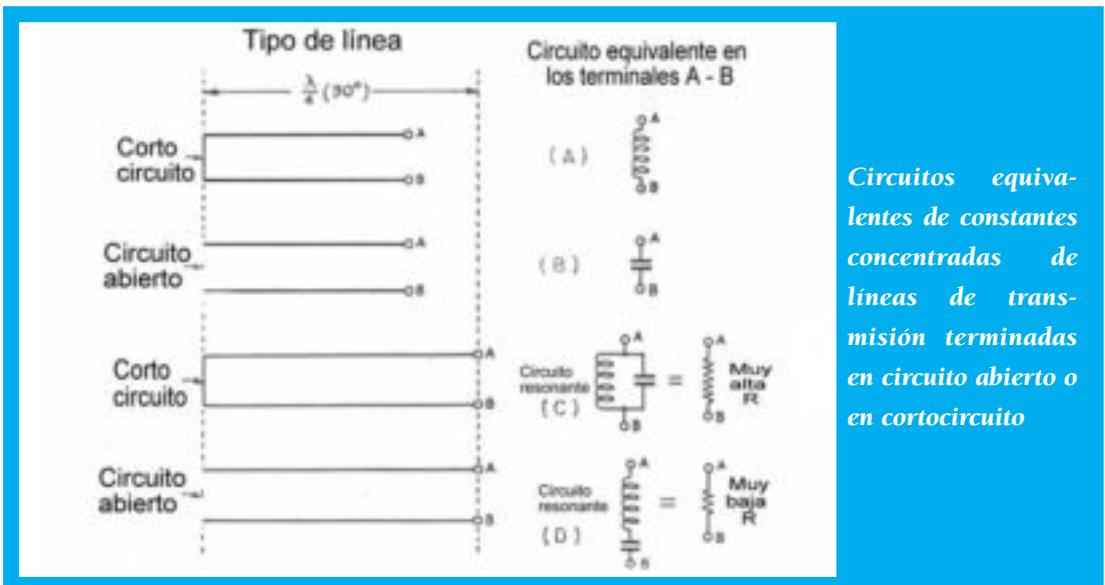
Cuando una sección de línea es usada como reactancia, la cantidad de reactancia está determinada por la impedancia característica y la longitud eléctrica de la línea. El tipo de reactancia mostrada en los terminales de entrada de una línea de una longitud determinada depende de la forma en que esté ter-
