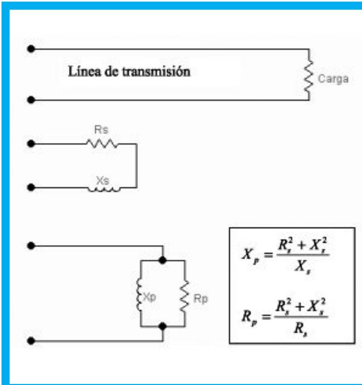
*Impedancia de entrada de una línea terminada en una resistencia pura; la impedancia de entrada se puede representar tanto con una resistencia y una reactancia en serie como en paralelo; la relación entre los valores de R y X en los circuitos serie y paralelo equivalentes está dada por las fórmulas. X puede ser inductiva o capacitiva, dependiendo del largo de la línea, de  $Z_0$  y de la carga*
