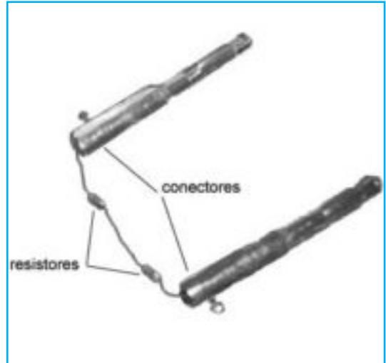
*Resistencia de carga de 200 ohm implementada con dos resistores de 100 ohm cada uno, conectados en serie*
