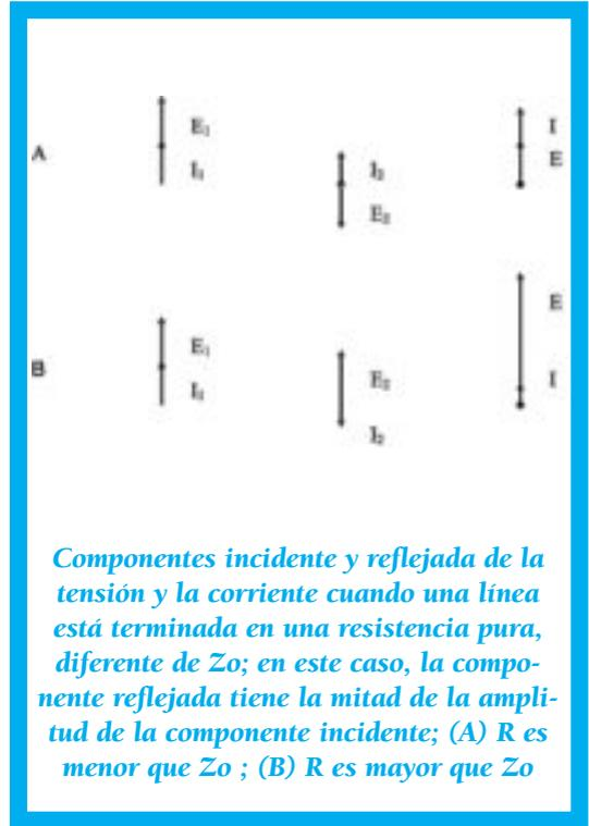
*Componentes incidente y reflejada de la tensión y la corriente cuando una línea está terminada en una resistencia pura, diferente de  $Z_0$ ; en este caso, la componente reflejada tiene la mitad de la amplitud de la componente incidente; (A) R es menor que  $Z_0$  ; (B) R es mayor que  $Z_0$*
