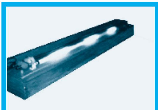
*Línea de Lecher construida en una caja contenedora. Debajo de los conductores paralelos está ubicado el tubo fluorescente encendido por zonas. Estas zonas iluminadas corresponden a regiones donde los campos electromagnéticos de la onda estacionaria presente en la línea son más intensos y mantienen la ionización.*
