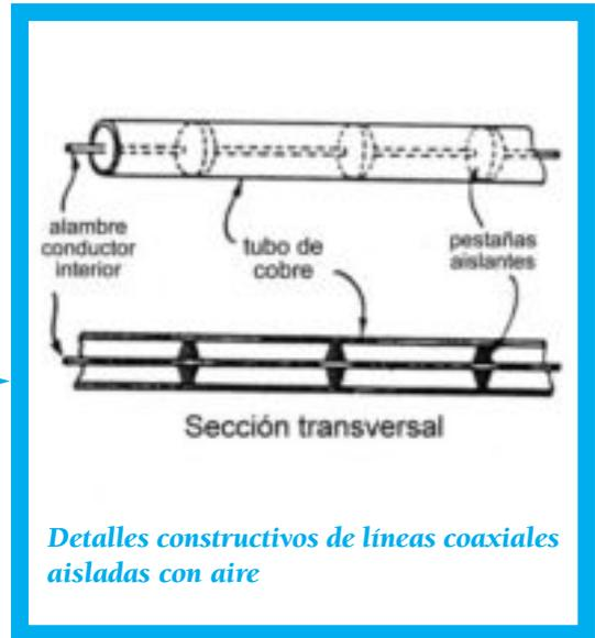
*Detalles constructivos de líneas coaxiales aisladas con aire*
