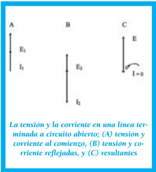
*La tensión y la corriente en una línea terminada a circuito abierto; (A) tensión y corriente al comienzo, (B) tensión y corriente reflejadas, y (C) resultantes*
