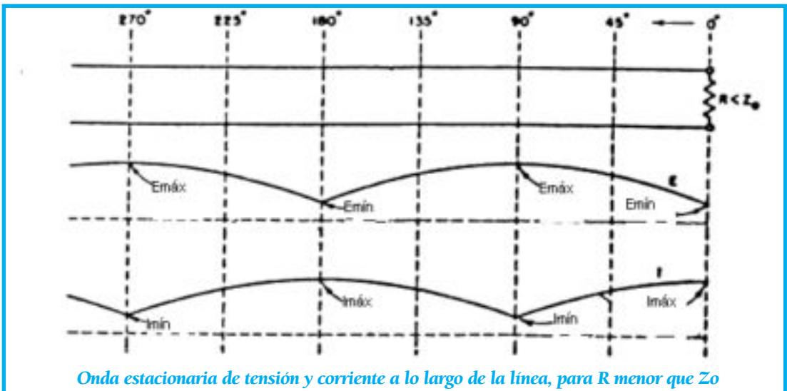
es mayor que en la carga ( $R$  menor que  $Z_0$ ) después de  $90^\circ$  o  $\frac{1}{4}$  de longitud de onda desde la carga, la tensión alcanza su máximo valor y la corriente su mínimo valor.
