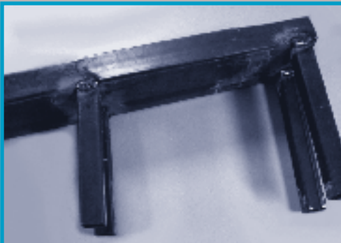
Soldadura eléctrica de los soportes
