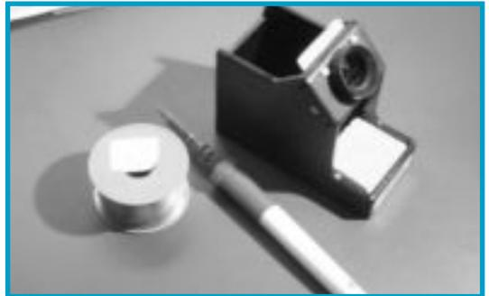
Con el soldador calentamos el pad y la pata de conexión para, luego, aplicar el estaño, que se funde inmediatamente, y recubre todo el pad y el pin, homogéneamente.
