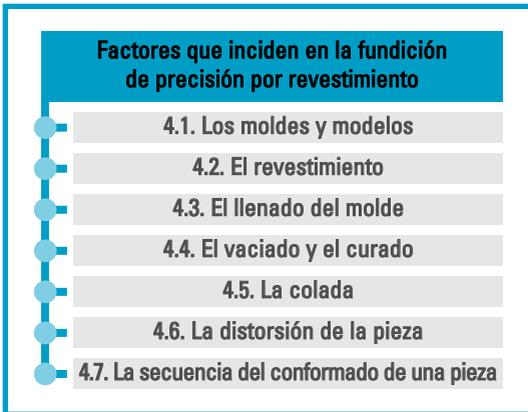
**4.1. Los moldes y modelos.** El modelo alrededor del cual se forma el molde final refractario puede ser de cera, plástico o mercurio.
