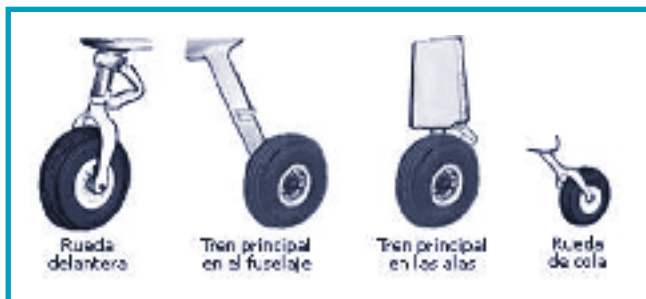
Tipos de tren principal y rueda direccional (M. A. Muñoz. www.manualvuelo.com )
