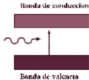
Los **fotodiodos PIN** se usan ampliamente como detectores en los receptores de fibra óptica. Su construcción presenta una región levemente impurificada, denominada región intrínseca, ubicada entre las regiones impurificadas con dopaje de impurezas tipo **p-** y **n-**. De aquí surge la denominación PIN -región P, región intrínseca, región N-. La región intrínseca proporciona un área altamente resistiva y relativamente grande para la interacción de los fotones.
