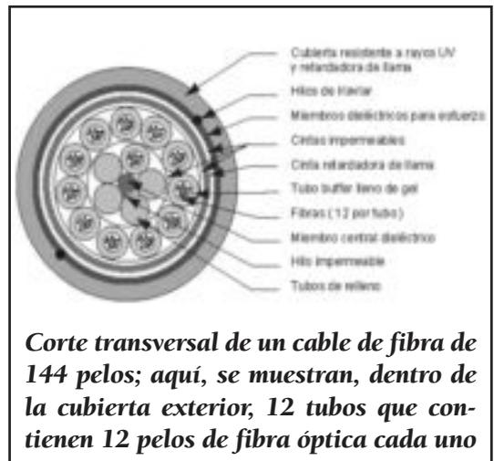
En general, este tipo de cable tiene una protección contra el agua mayor que los cables aéreos. Porque, si bien suelen instalarse dentro de conductos enterrados en el suelo a
