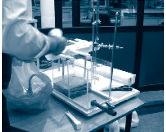
4.4. Luego, se coloca una capa de 2 cm de carbón vegetal y, a continuación, se completa el filtro agregando arena muy fina, previamente calcinada - esto se logra colocándola al fuego en una lata, hasta que se pone oscura y corre libremente-.
