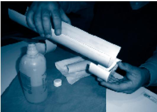
3.4. Se unen las partes pegadas con una morceta durante 20 minutos, para lograr un fraguado óptimo.
