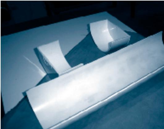
3.3. Se pegan las tapas en los extremos del caño de desagüe con un adhesivo especial para PVC.
