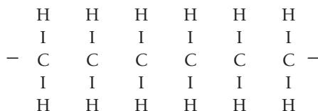
Molécula de polietileno que resulta de la conversión del doble enlace \text{C}=\text{C} en dos enlaces sencillos \text{C}-\text{C}
